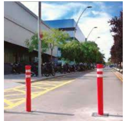
Figura 3. Fita de protecció mecànica
